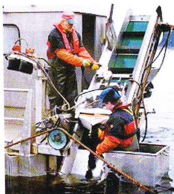
Færiband notað til að flytja krækling upp í skip ( www.affjord.net/skjell ).
