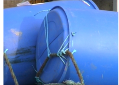
Flot fest á tvær burðarlínur. Borað í tunnu og fest með nokkrum böndum í burðarlínu.
