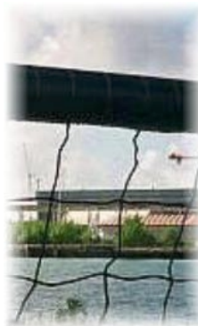
Mynd 4.16. Plaströr sem flot og burðarlína í kræklingastöð í Noregi (Aspøy Skjell og Produktutvikling).
