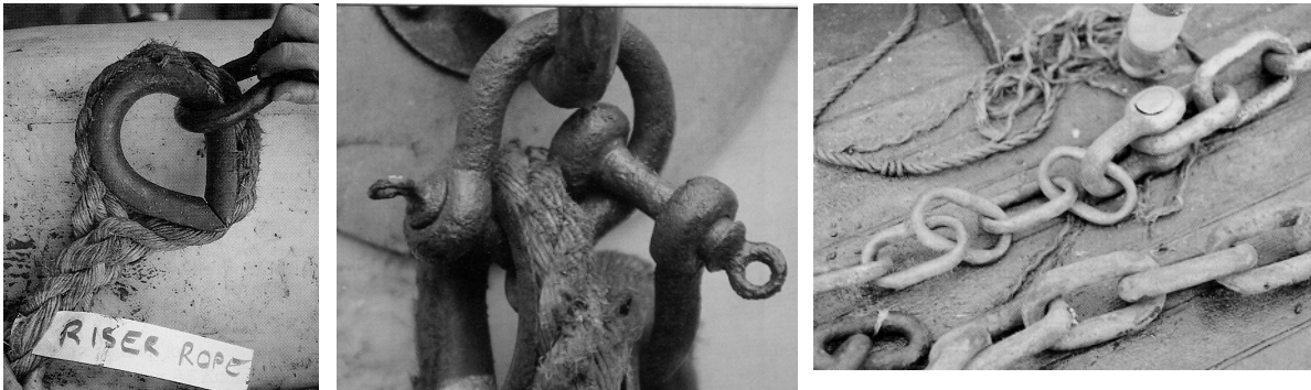
Kós færst til í Dæmi um rangan frágang. Kaðall Mismikið slit á keðjum. augnsplæsi. byrjaður að slina.
