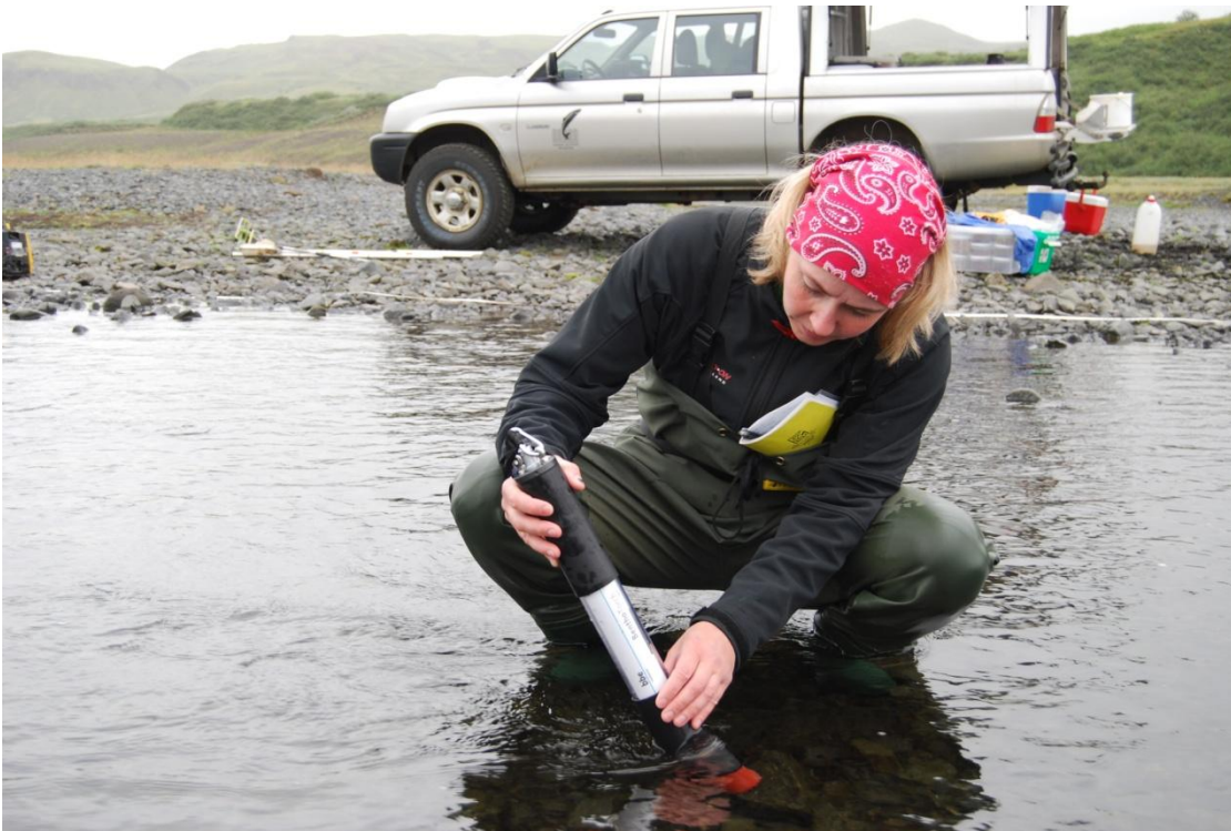
8. ljósmynd. Þörungamagn mælt með Benthos Torch blaðgrænumæli.
